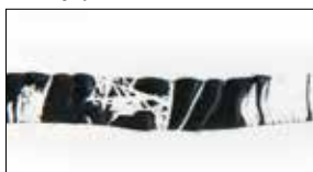
Afb. 4: Goede hechting met cohesieve lijmbreuk in de ondergrond
