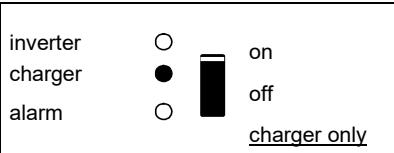
La tension d'entrée CA est commutée et le chargeur fonctionne en mode Bulk ou absorption.
