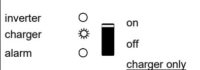
Die Wechselspannung ist durchgeschaltet und das Ladegerät arbeitet im Spannungs-Erhaltungsmodus
