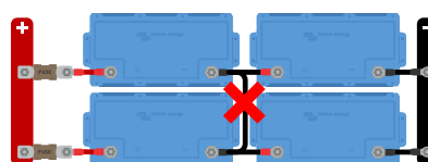
Verbind de middelpunten niet met elkaar en verbind niets anders met de middelpunten.
